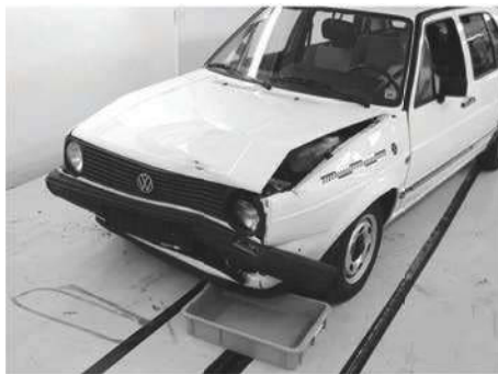
Bild 1.9a Beschädigungsumfang Golf II nach 15-km/h-Crash [Quelle: AZT]
