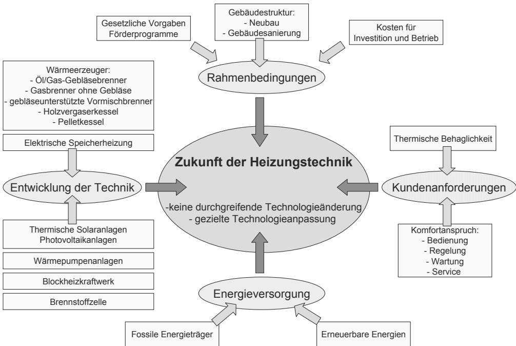
Bild 1.1 Mögliche Entwicklungstendenzen in der Heizungstechnik
