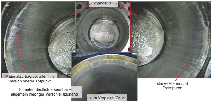
**Bild 3.83** Adhäsiver Verschleiß und Fresser an Zylinder 3, Zylinder 2 zum Vergleich
